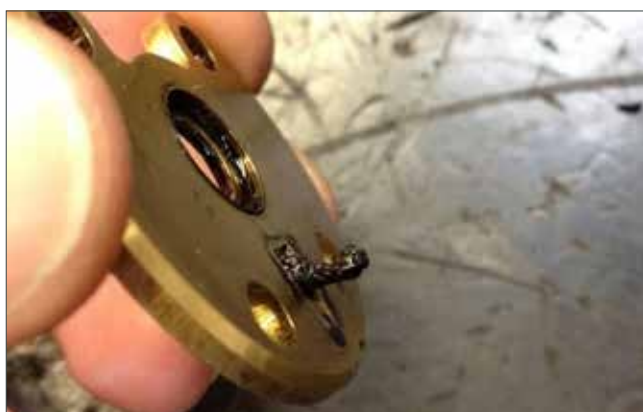
Tief eingelaufenes Axiallager eines Turboladers mit durch Dichtmasse verstopfter Ölbohrung
