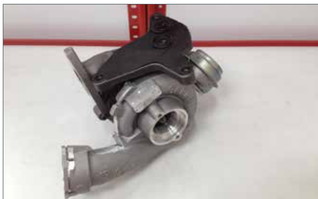
Neuer Turbolader mit alter Flanschdichtung und viel Dichtmasse.
